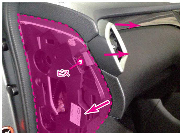
助手席側のダッシュボードサイドパネルの手前を外側に引っ張る様にして取り外し、エアコン吹き出し口のビスを取り外し、吹き出し口を取り外し、化粧パネルを左から取り外して下さい。
