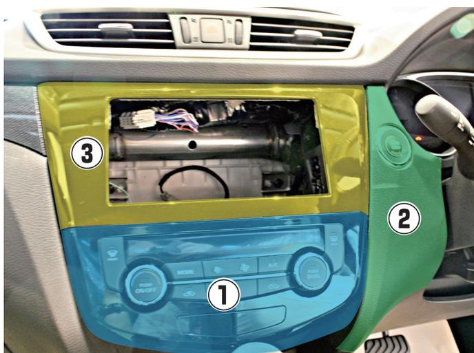
①エアコンパネル、②エンジンスタートパネル、③オーディオパネルの順で取り外して下さい。各パネルはクリップ等で固定されていますので、手前に引く様にして取り外して下さい。
