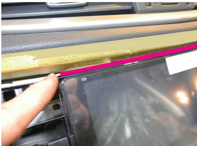
NAVI を車両へ仮付けし、インストルメントパネルと NAVI の上部が干渉しない事を確認して下さい。
