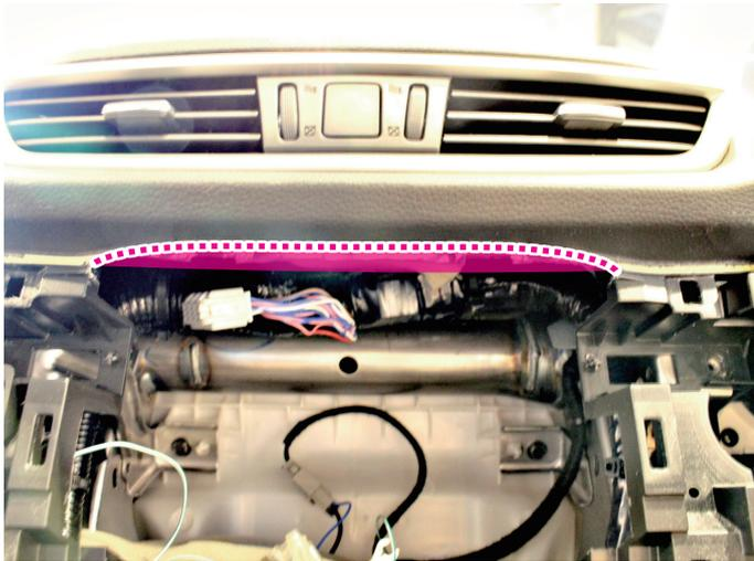
インストルメントパネルを左図破線部の位置でホットナイフ等でカットして下さい。
